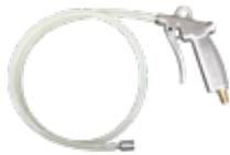
→ Für die bewertungskonforme Bohrlochreinigung mit Druckluft für Bohrlöcher ab 16 mm Durchmesser
