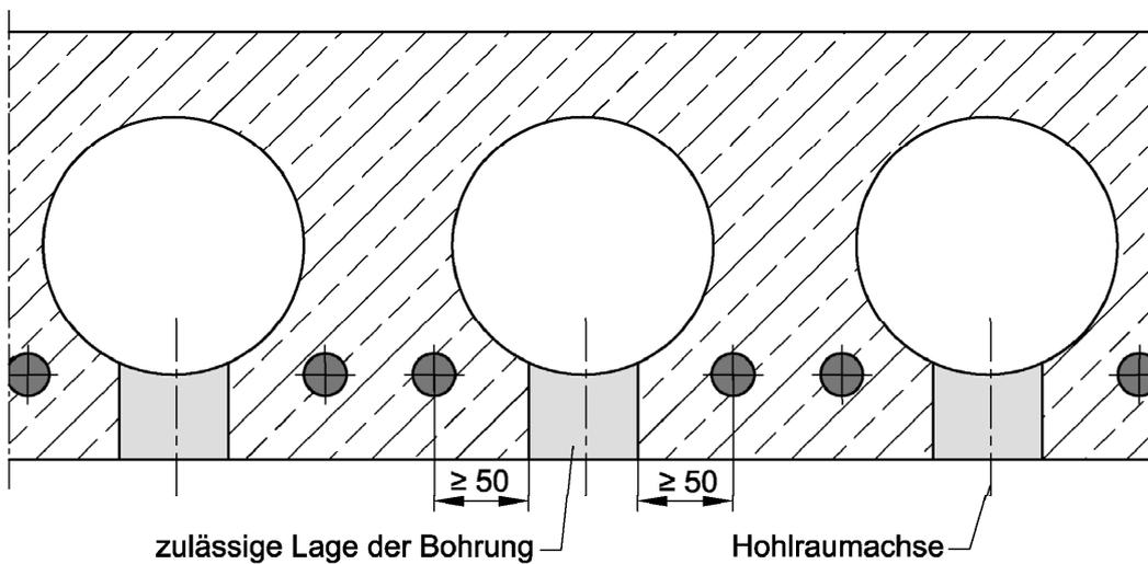
Wird der Dübel nicht mittig in die Hohlraumachse gesetzt, so muss der Abstand zwischen der Dübelachse und der Achse der Spannleiste mindestens 50 mm betragen, entsprechend der o.g. Darstellung. Der Dübel kann sowohl im Vollmaterial der Hohlplatte, als auch von oben in die Hohlplatte eingebaut werden.
